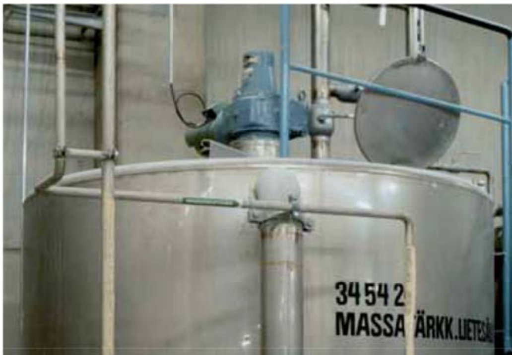
Covera worm gearbox CVTM-1250 for agitator application. Covera Schneckengetriebe CVTM-1250 in der Rührwerks-Anwendung.
